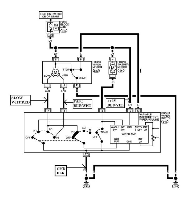
GROUND SIDE SWITCHING WIPERS RUN WHEN GROUND APPLIED TO WIPER MOTOR SLOW OR FAST TERMINALS. MOTOR COMMON AT +12V.
